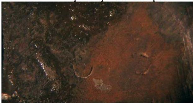
**Рис. 3. Потемнение площадки после химического травления сплава АЛ-4 в водном растворе 10%-й соляной кислоты и 0,3%-го хлорного железа**
