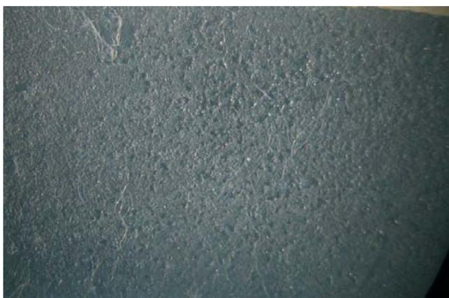
**Рис. 1. Отсутствие растворения сплава АЛ-4 при использовании в качестве травителя 30%-й азотной кислоты**
