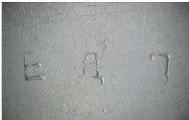
**Рис. 4. Восстановление обозначений на сплаве Д-1 в результате электрохимического травления в 20%-м водном растворе соляной кислоты**
