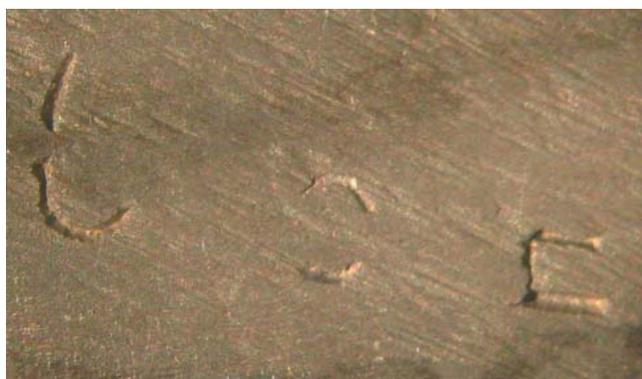
**Рис. 5. Восстановление обозначений на сплаве АД-0 в результате химического травления в 25%-м водном растворе едкого натра**
