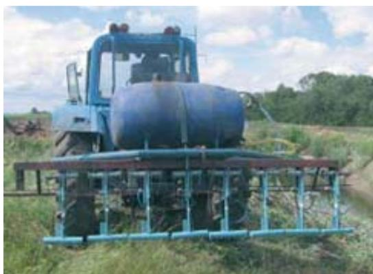
Рис. 6. Работа устройства для подавления пней во время полевых испытаний
