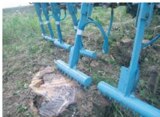
Рис. 7. Подавление пней с механическим воздействием и внесением арборицида.
