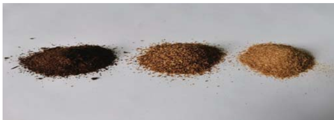
Рис. 1. Цветность образцов зерновой клетчатки, полученных в сушилках: 1 – роторно-трубчатая сушилка с кондуктивным паровым обогревом; 2 – барабанная сушилка с конвективным обогревом горячим воздухом; 3 – вихревая сушилка спирального типа с конвективным обогревом горячим воздухом.
