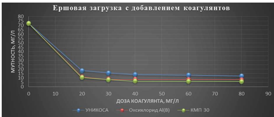
Рис. 15. Изменение мутности и цветности воды при ее фильтрации на пилотной установке с ершовой загрузкой с добавлением коагулянтов
