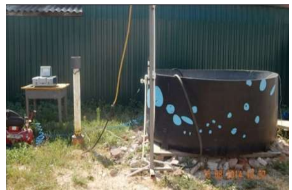
Рис. 12. Экспериментальная установка и технологическая схема: 1 – бассейн с сине-зелеными водорослями; 2 – лавсановые ерши; 3 – место отбора проб профильтрованной воды; 4 – компрессор для регенерации фильтра; 5 – насос; 6 – подача исходной цветущей воды; 7 – отвод воды после промывки фильтра; 8 – насос-дозатор раствора коагулянта; 9 – задвижка
