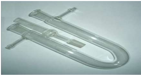
Рис. 1. U-образная трубка с графитовым анодом и катодом
