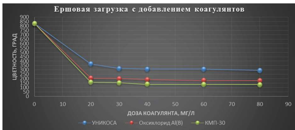
Рис. 16. Изменение мутности и цветности воды при ее фильтрации на пилотной установке с ершовой загрузкой с добавлением коагулянтов
