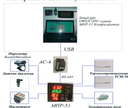
Рис. 2. Схема системы управления сушкой зерна на базе измерителя-регулятора МПР-51-Щ4
