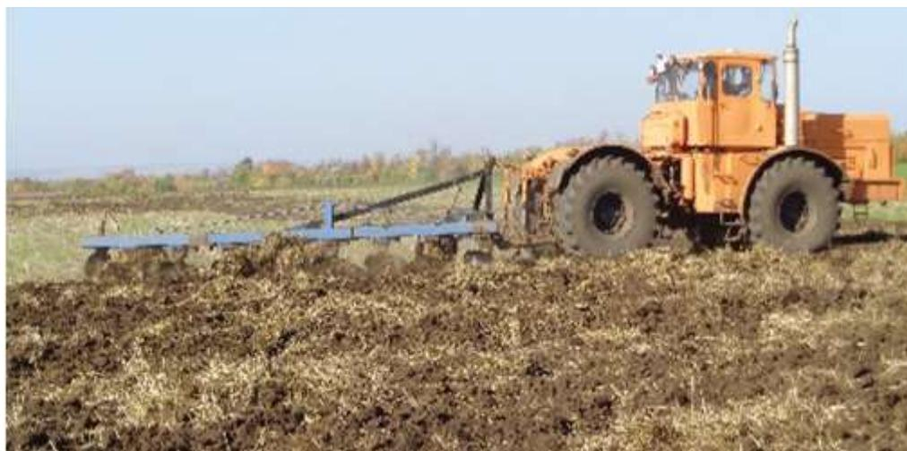
Рис. 1. Пахотный агрегат К-701+ПНЛ-8-40
