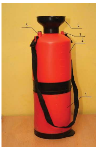
Рис. 1. Ранцевая дезинфицирующая система РДС-6: 1 – блок управления с двумя адаптерами, которые обеспечивают питание электрохимического генератора: один от сети переменного тока 220В, а другой от аккумуляторного источника постоянного тока напряжением 12-27В, а также систему автоматики, обеспечивающую технологические и защитные функции электролиза; 2 – многофункциональная емкость, выполняющая функцию двух различных устройств: реактора, обеспечивающего электролиз хлорсодержащего раствора и распылителя, включающего ручной воздушный насос, способный создать необходимое рабочее давление; 4 – горловина рабочей емкости, на которой поочередно закрепляются вначале реактор, а затем воздушный насос; 5 – предохранительный клапан; 3 – штуцер для подключения браншпойта [1]
