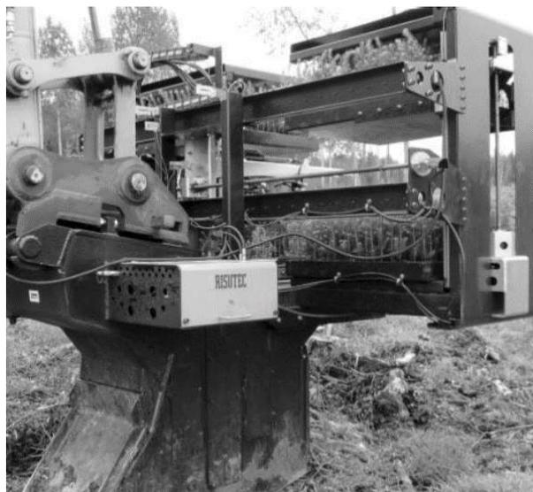
Рис. 5. Посадочное устройство Risutec APC
