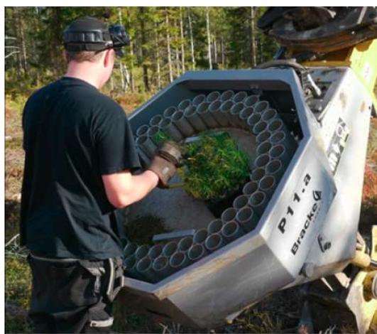
Рис. 4. Загрузка оператором сеянцев в посадочный аппарат Bracke P11.a
