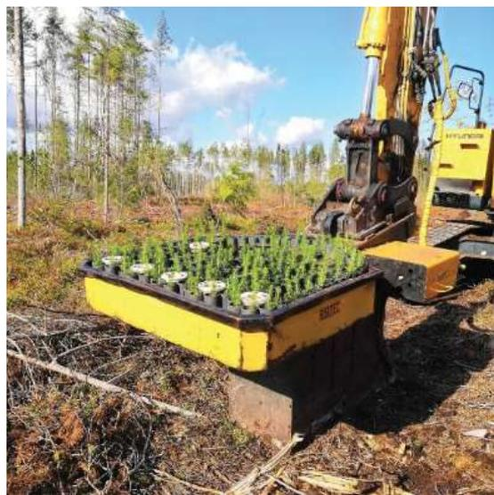
Рис. 6. Посадочное устройство Risutec
