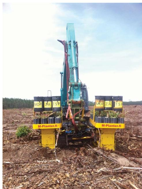
Рис. 7. Лесопосадочное устройство M-Planter с двумя посадочными головками
