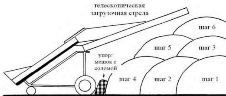
Рисунок 1 – Последовательность формирования насыпи при помощи транспортёра загрузчика с телескопической стрелой
