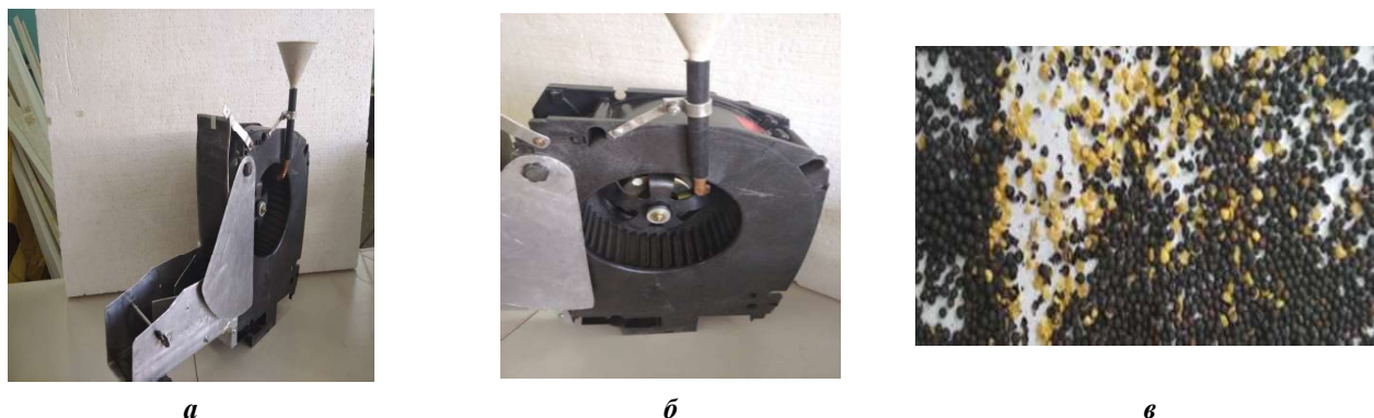
Рисунок 1 – Лабораторное устройство для шелушения семян рапса: а, б – устройство; в – частично шелушенные семена рапса
