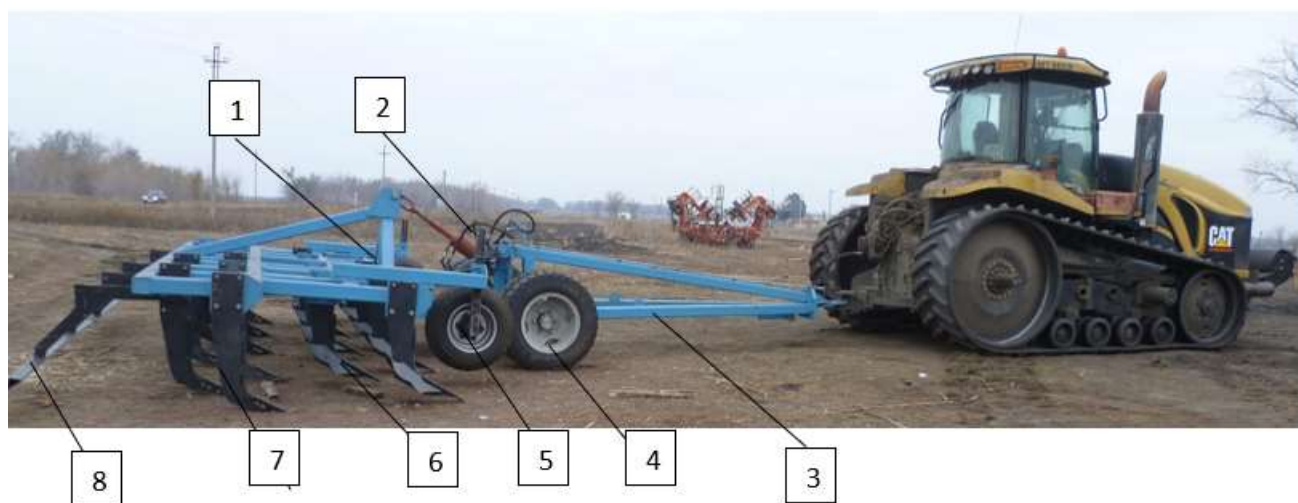
Рисунок 1 – Плуг-рыхлитель КОМБИ-7 в агрегате с трактором Challenger-865B Figure 1 – Plow-ripper COMBI-7 in conjunction with the Challenger-865B tractor
