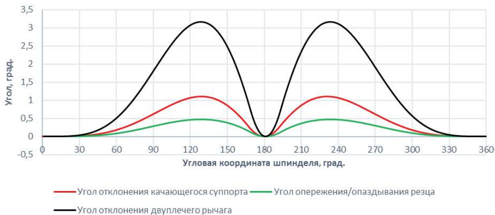
Рисунок 10 – Углы отклонения качающегося суппорта и двулучевого рычага
