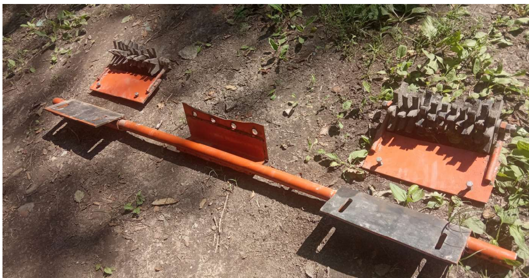
Рисунок 3 – Комбинированный очиститель протектора колесного движителя
