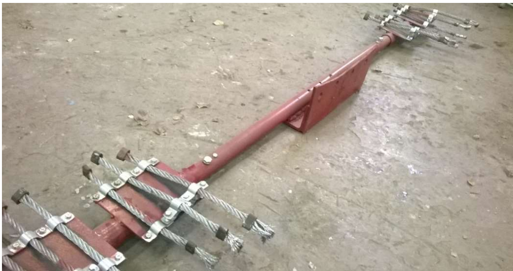
Рисунок 2 – Опытный торсионно-тросовый очиститель протектора колесного движителя
