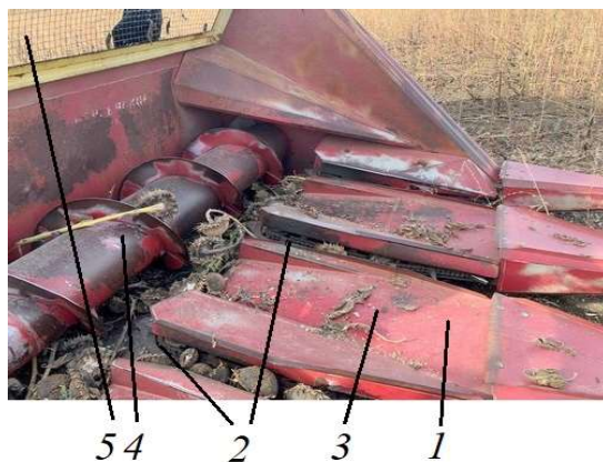
Рисунок 1 – Адаптер НАШ-873: 1 – лифтер; 2 – цепные транспортеры стеблей; 3 – вибротранспортер корзинок и маслосемян; 4 – шнек адаптера; 5 – фартук
