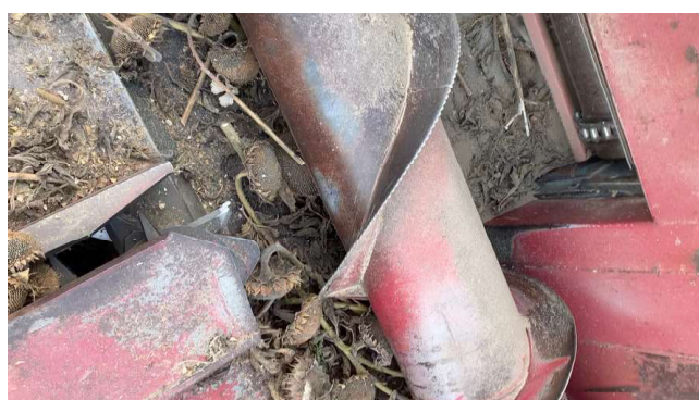
Рисунок 5 – Маслосемена, осыпанные на днище адаптера от воздействия рабочих органов
