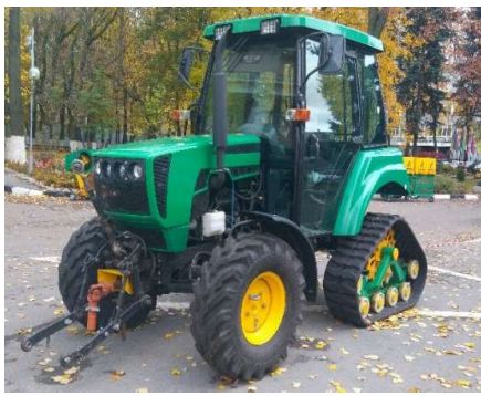
Рисунок 1 – Трактор Беларус-622 со съемной гусеничной ходовой системой ведущего моста
