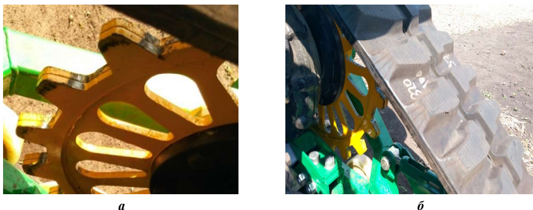
Рисунок 4 – Характер износа зубьев ведущих колес: а – правого модуля СГХС; б – левого модуля СГХС
