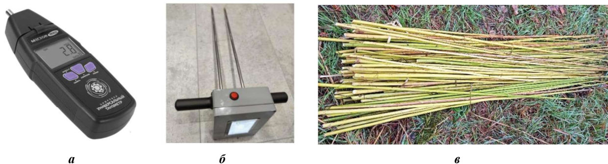
Рисунок 2 – Измерительное оборудование и растительный материал: а – цифровой тахометр МЕГЕОН-1800Х; б – цифровой влагомер ВЛТЗ; в – образцы стеблей технической конопли
